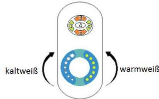
Einstellung der Helligkeit und Farbtemperatur: Über die Sensorfläche kann die Helligkeit und die Farbtemperatur eingestellt werden
