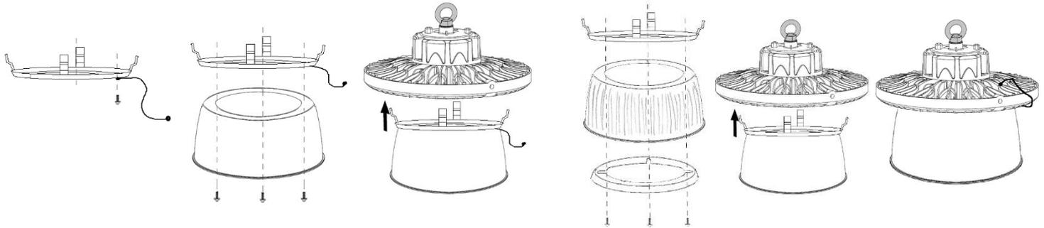
**Installation mit LED High Bay 46 PMMA-Reflektor 60°/ Installation with: LED High Bay 46 PMMA-Reflector 60°:**
